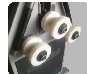
Alüminyum ve Paslanmaz Kıvrırma İçin Özel Plastik Vals Topları Delrin Rolls For Aluminum And
